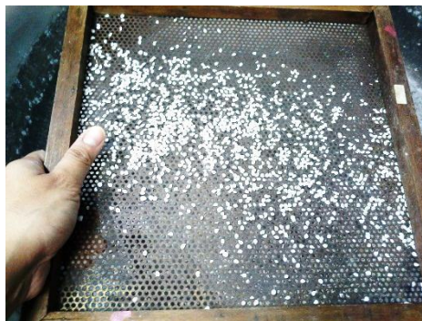
ตะแกรงคัดขนาด ขนาดเส้นผ่าศูนย์กลาง 2 มม.
