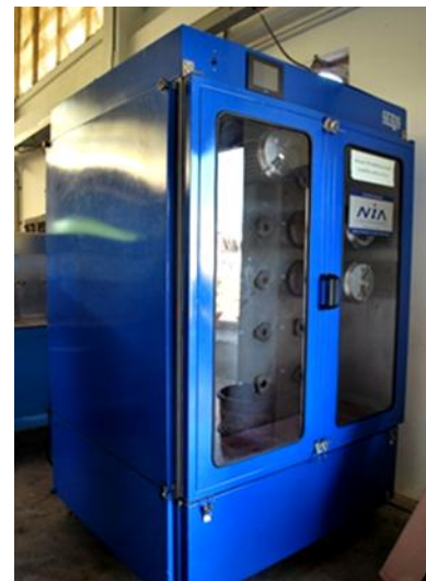
ลดความชื้นด้วยเครื่อง SKK 09 ที่อุณหภูมิ 35°C
